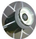
镜头直径为40mm，带图像自动水平功能
